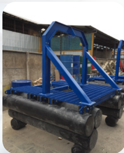
Fabricación de balsas para bombas verticales
